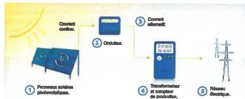
Figure 5 : Schéma descriptif du fonctionnement des modules solaires
