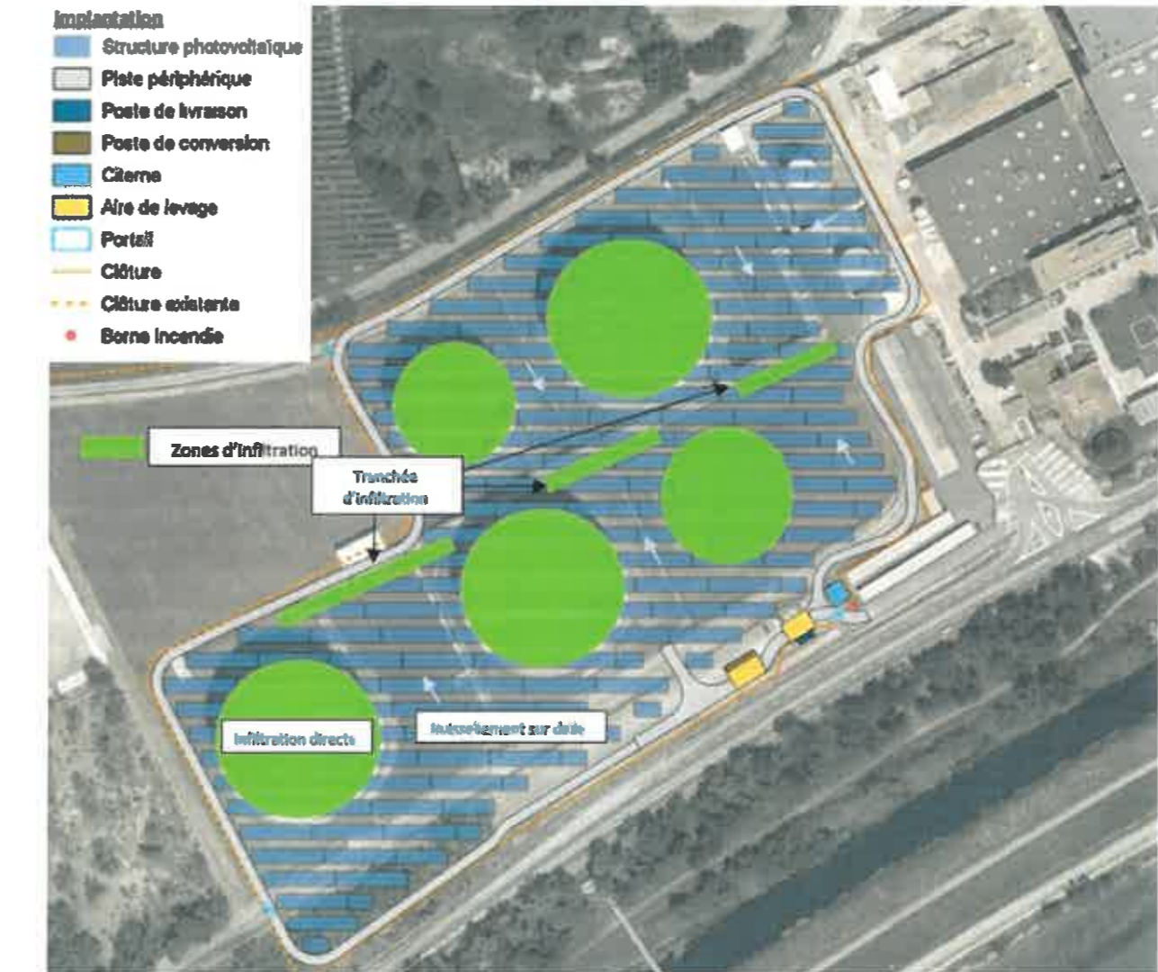
Figure 130: Principes de gestion des eaux pluviales
